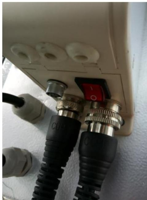
Рис. 8. Клавиша включения и выключения питания чаши.
